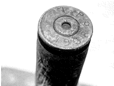
Beina de bala del calibre 7x57 fabricada a la Fàbrica Nacional de Palència l'any 1938, inscripció «FNP 1938» (esquerra). Vista de dues bales ja disparades fetes de plom i recobertes de llautó i de coure, localitzades al camp de tir del collet de Puig Porquer (dreta).
