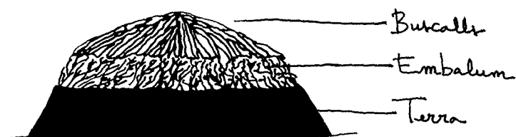
Fases de construcció de la carbonera
