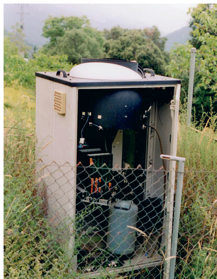
Foto 2. Col·lector de pluja del tipus situat a Santa Maria de Palautordera. Consta d'una cúpula semicircular que s'obre en començar a ploure. La pluja es vehicula cap a un bidó a l'interior del col·lector. ©Anna Avila
