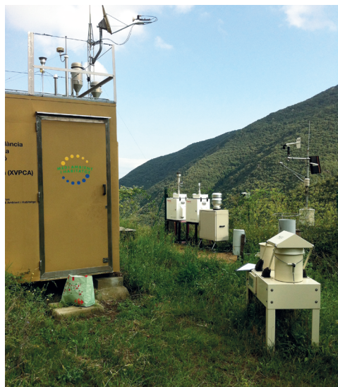
Foto 1. Estació de mesura de la qualitat de l'aire a La Castanya. El col·lector de pluja és l'instrument blanc del primer pla. Consta d'una tapa que es mou per deixar descobert el cubell on es recollirà la pluja. ©Anna Avila
